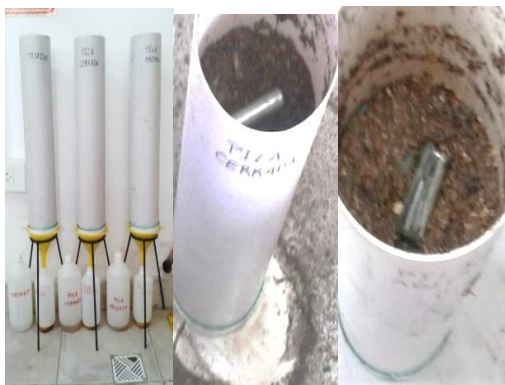
Figura 2: Columnas de percolación según Norma ASTM E2242-02 (2012).
