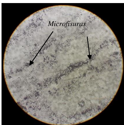
Figura 9. Microfotografía del álabe N° 5. Se observa unión de microfisuras. Año 2018.
