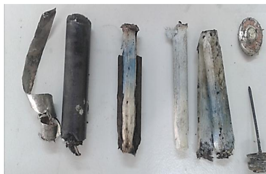
Figura 3: Componentes de pilas alcalinas
