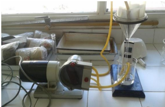
Figura 6: Columna de percolación recuperación de Zn y Mn.
