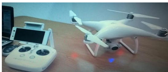
Figura 2: Cuadricóptero DJI Phantom 4 con cámara RGB, utilizado para la captura de datos.
