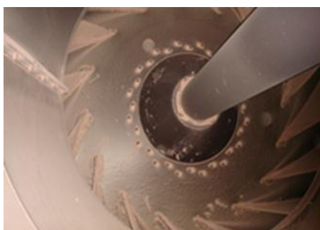
Figura 4. Fotografía de los álabes del ventilador. Se puede observar parte de la carcasa.
