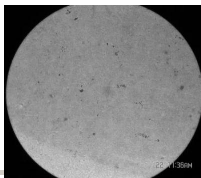
Figura 6. Microfotografía del álabe Nº 5 del ventilador. Año 2004. Se puede observar una tenue precipitación de microfases tipo carburos.
