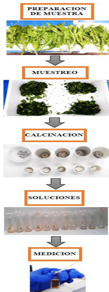
Figura 1: Proceso de obtención y digestión de materiales experimentales (hojas de achicoria para la determinación de la concentración de hierro).
