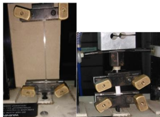
Figura 3. Ensayos de tracción en muestra de PEBD y de PS expandido
